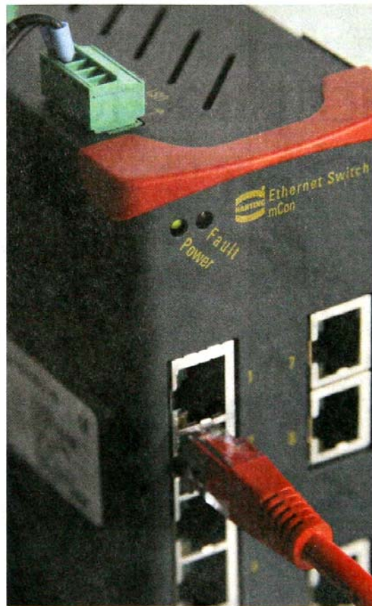
Ethernet-Switches als „Verteilstellen“ für Datenströme im Schaltschrank sind ein wichtiger Baustein für Webautomation im Unternehmen. Foto: Harting
